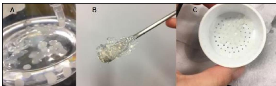
Figura 18: Cápsulas de alginato obtenidas por método de goteo. A) cápsulas grandes de aproximadamente 1 cm obtenidas con boquilla de jeringa. B y C) cápsulas de 3-5mm obtenidas con una aguja de 0,8 mm x 40 mm. Se obtuvieron capsulas de mayor tamaño al esperado.
