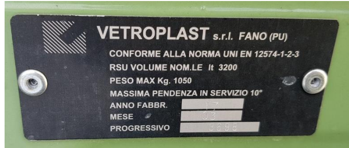
Ilustración 4: etiqueta de contenedor tipo B
