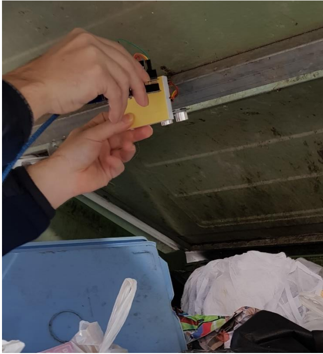
Ilustración 45: sensor en ubicación superior
