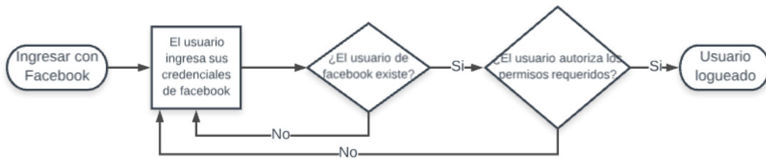
Ilustración 8 - Diagrama de flujo del requerimiento funcional número dos de la aplicación de clientes: Integración con Facebook.
