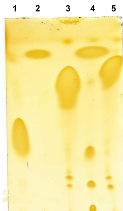
Figura 33: Cromatografía hidrofóbica (TLC) para evaluación de la generación de biodiesel; Carril 1: Ácido oleico; Carril 2: Oleato de etilo; Carril 3: Aceite alto oleico Carril 4: Muestra TLL sílica 24hs; Carril 5: Control muestra sílica sola. Hay producción de oleato de etilo.
