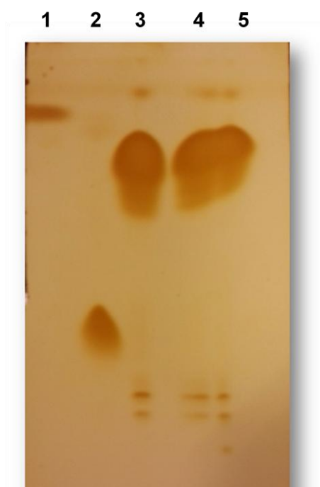
Figura 32: Cromatografía hidrofóbica (TLC); Carril 1: oleato de etilo; Carril 2: Ácido oleico; Carril 3: Aceite alto oleico; Carril 4: muestra BTL2 1h; Carril 5: muestra BTL2 72 h. No se observa la generación de oleato de etilo para las muestras de BTL2 en la mezcla de reacción. En las muestra de BTL2 72hs hay presencia de monoglicéridos y diglicéridos (1,2 o 1,3) mientras que en la muestra de BTL2 1h sólo hay presencia de monoglicéridos.
