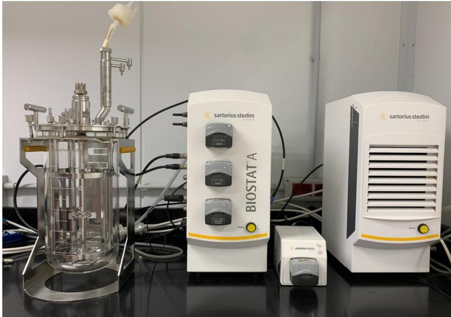
**Figura 5. Biorreactor Sartorius BIOSTAT A de 5 L utilizado en el proyecto.**
