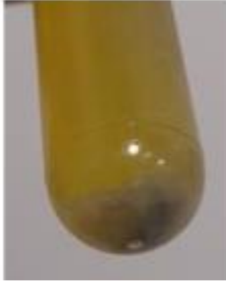
Figura 16. Precipitado gris en el fondo de un tubo conteniendo CF, el cual fue almacenado durante 2 meses en heladera a una temperatura de entre 2°C y 14°C.
