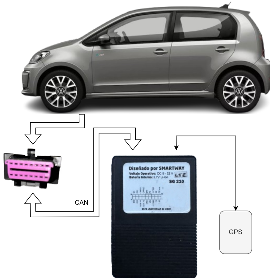
Figura 3.18: Diagrama del Dispositivo SG instalado en Volkswagen e UP
