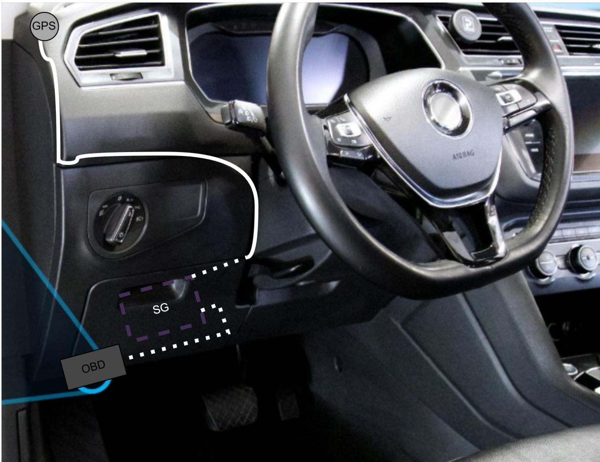
Figura 3.17: Instalación del Dispositivo SG de Smartway en Volkswagen e UP
