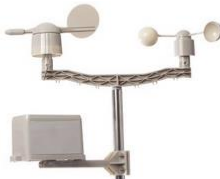
Figura 10 – Anemómetro de aspas utilizado en nuestro proyecto – Sparkfun Fuente: [34]
