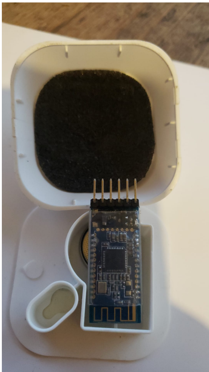
Figura 5.14: Carcasa para módulo HM-10 y pila CR2025.
