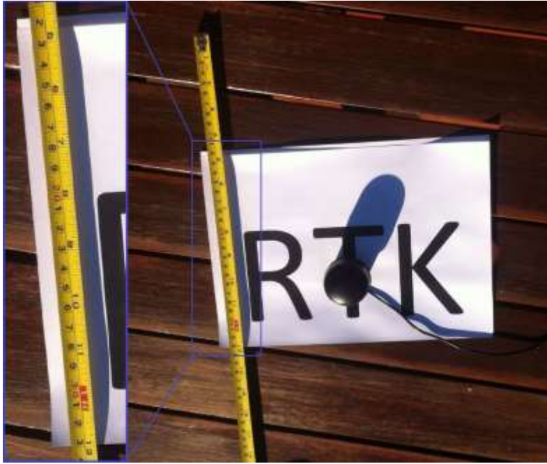
Ilustración 49 - Impresión para pruebas de precisión con letra de 10 cm de altura
