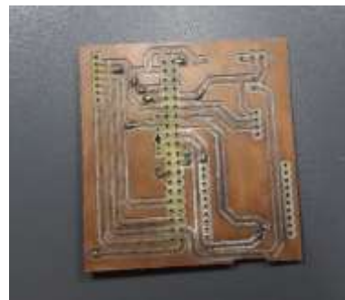
Ilustración 42 - Construcción de PCB lado superior
