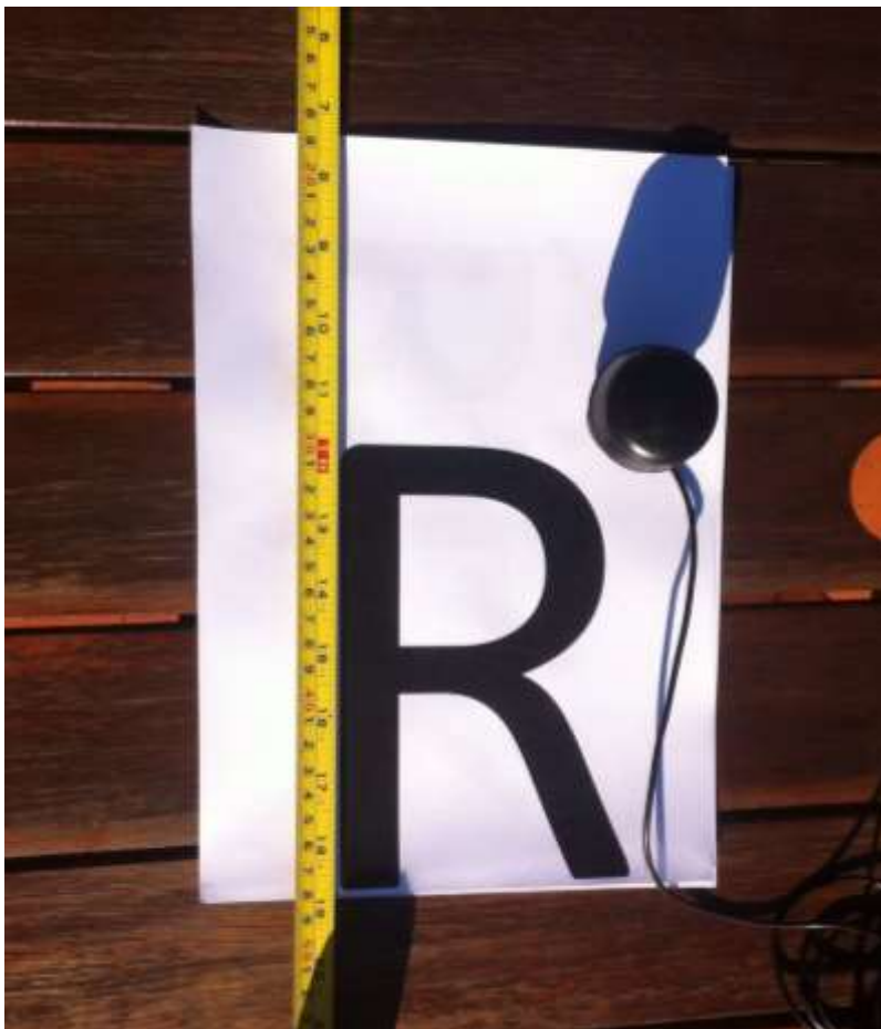
Ilustración 50 - Impresión para pruebas de precisión con letras de 18 cm de altura
