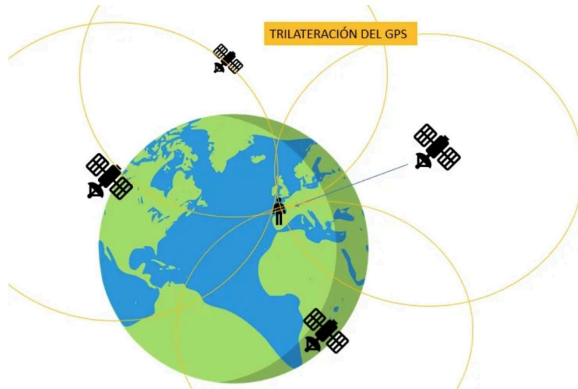
Figura 3.13: Esquema de Trilateración [21]
