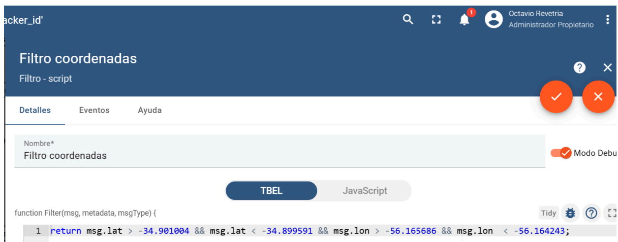
Figura 7.19: Código en el bloque “Filtro coordenadas” para validar el geovallado
