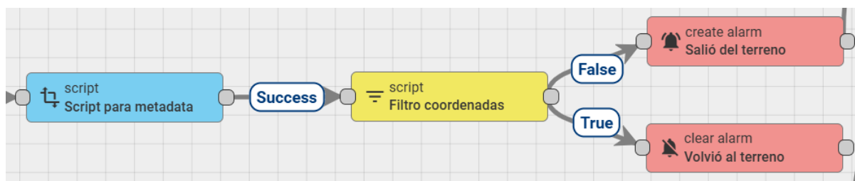
Figura 7.18: Captura de la regla de cadena con el bloque script “Filtro coordenadas”
