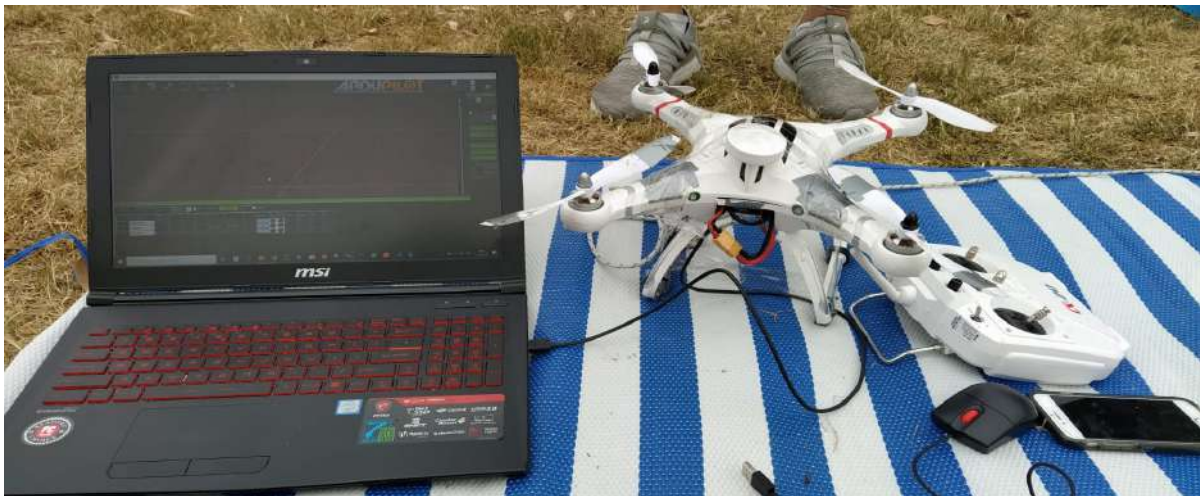
Ilustración 74: Dron conectado a una PC ejecutando el plan de vuelo
