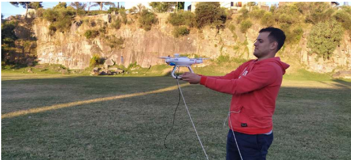
Ilustración 75: Despegue de dron atado a una cuerda
