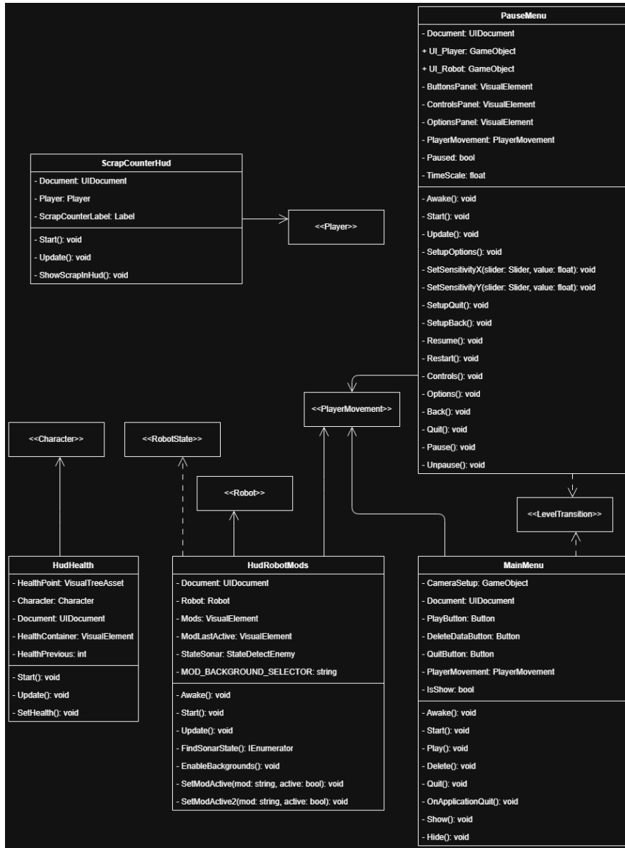
Figura 15: Diagrama de clases (UML) del módulo Menu .
