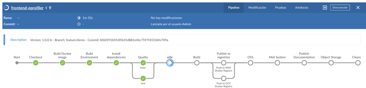
Figura 5.26: Ejemplo de workflow de integración continua de aplicación de frontend.
