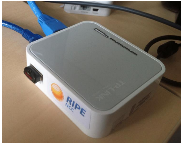
Figura 3.1 – Probe de RIPE atlas [42]
