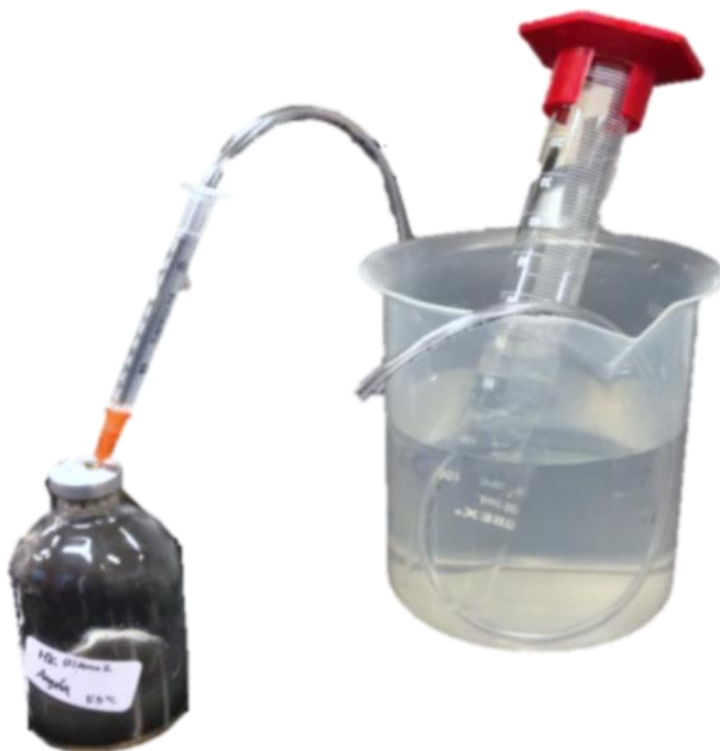
Figura 12. Dispositivo de medición del gas producido. El dispositivo está compuesto por un vaso de bohemia de 1000 mL con la mitad de agua conteniendo una probeta graduada invertida de 100 mL llena de agua. Del interior de la probeta invertida sale un tubo que la conecta con la jeringa (sin el émbolo) inyectada en el vial, permitiendo el pasaje del gas hacia la probeta.
